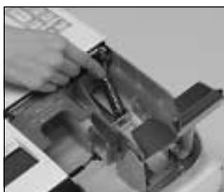
3. Noter les repères (+) et (-) dans le logement des piles. Insérer un jeu de deux piles alcalines neuves de sorte que les pôles positifs (+) et négatifs (-) soient dirigés dans le sens indiqué par les repères.
